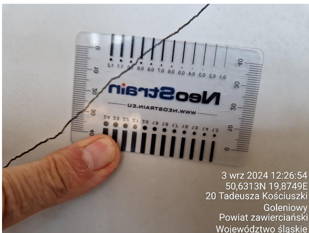
Fot. 18. Pomiar zarysowań ściany północnej cz. I.
