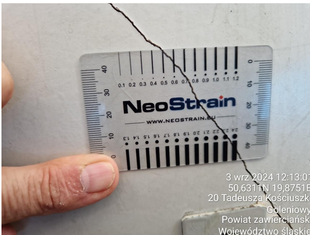
Fot. 10. Pomiar zarysowań ściany południowej cz. I.
