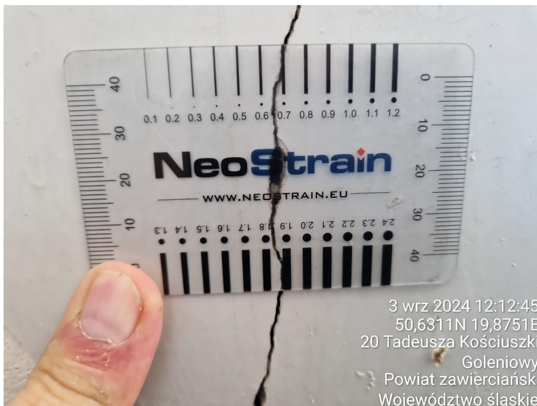
Fot. 9. Pomiar zarysowań ściany południowej cz. I.
