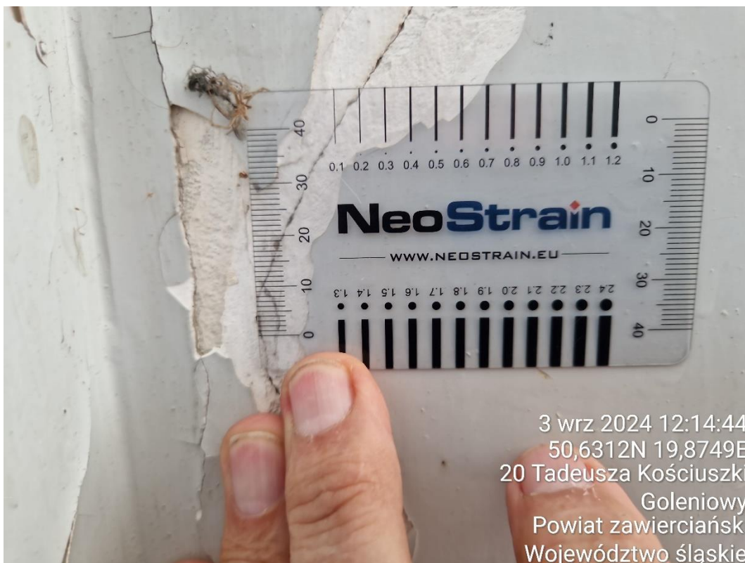
Fot. 12. Pomiar zarysowań ściany południowej cz. I.
