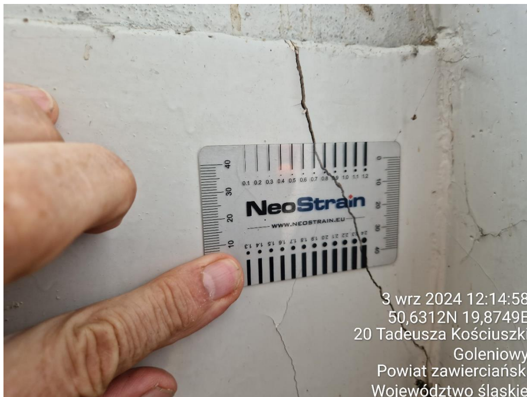
Fot. 13. Pomiar zarysowań ściany południowej cz. II.
