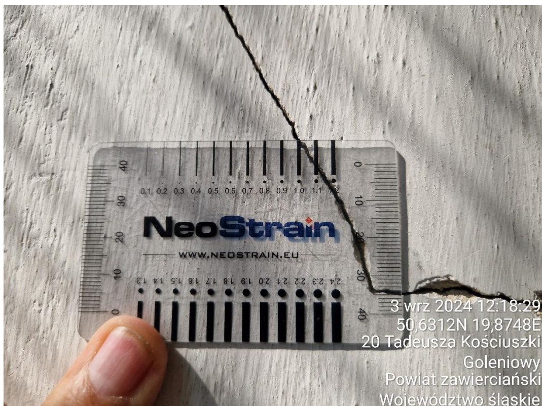
Fot. 5. Pomiar zarysowań ściany zachodniej od strony okien.
